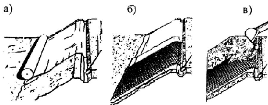
а – устройство фильтра из Геотекстильного материала, б – укладка пространственной георешетки, в – заполнение ячеек георешетки
