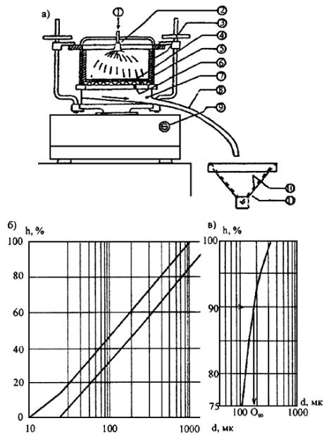
а – схема испытаний; б – рекомендуемый гранулометрический состав грунта;
