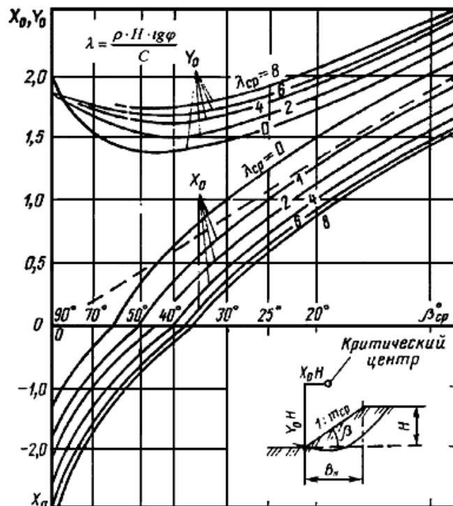
Рисунок 11.7 – График для определения положения линии скольжения
