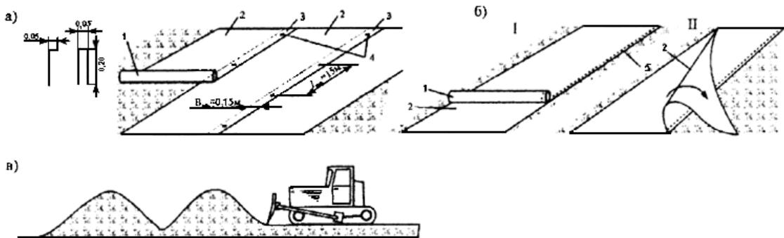
1 и 2 – рулон и полотно ГМ; 3 – перекрытие полотен; 4 – анкера; 5 – соединение (сшивание) полотен по краю
