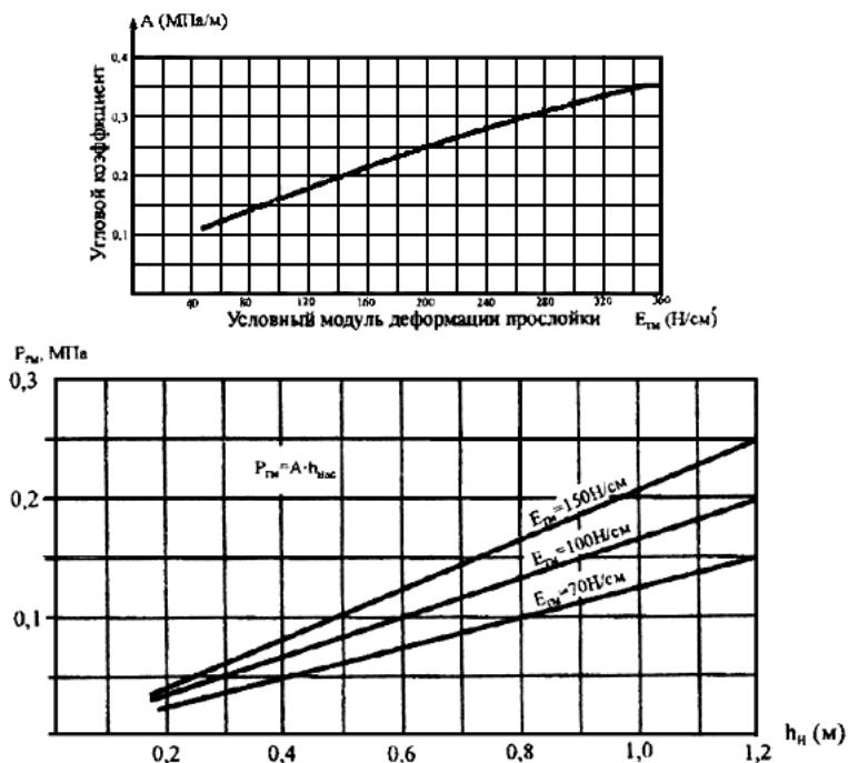
Рисунок Г.1 – Зависимость допустимой нагрузки  $P_{Gm}$  (МПа) на геосинтетическую прослойку от толщины тонкослойной насыпи  $h_n$  (м) при  $P_0=0,6$  МПа;  $D_0=36-38$  см; допустимой величины колеи  $S=10$  см
