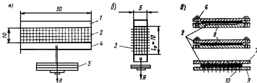
1, 4 – зажимы; 2 – ГМ; 3 – накладки; 5 – грузы; 6 – стяжка; 7, 8 – верхняя и нижняя накладки; 9 – накладка с отверстием под шипы; 10 – шипы
