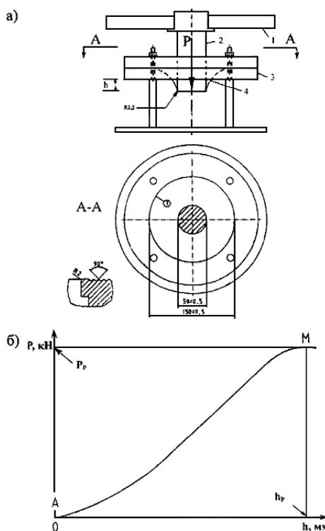
а – схема испытаний; б – результирующая зависимость; 1 – система ручного перемещения штампа – цилиндра; 2; 3 – зажимы; 4 – ГМ; Р – усилие продавливания;
