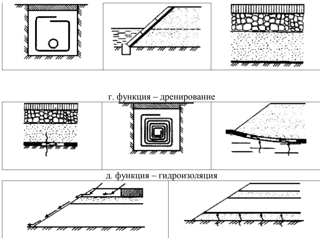
Рисунок 5.1 – Основные функции геосинтетических материалов в дорожных конструкциях
