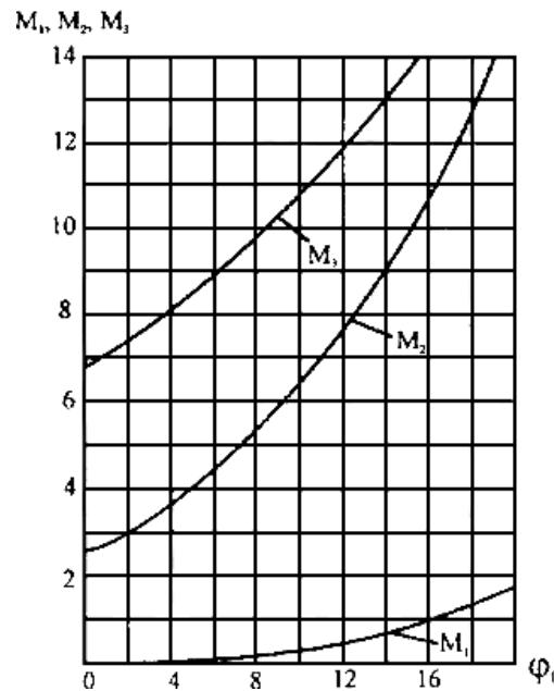
Рисунок 8.9 – Зависимость коэффициентов M<sub>1</sub>, M<sub>2</sub>, M<sub>3</sub> от угла внутреннего трения грунта слабого основания
