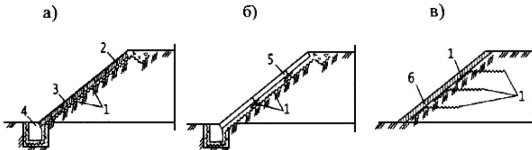
1 – ГМ; 2 – решетка; 3 – заполнение решетки; 4 – упор; 5 – бетонная плита; 6 – защитный слой
