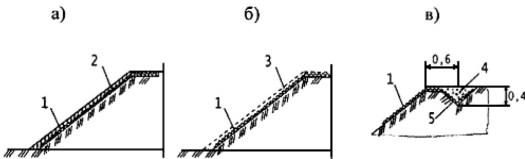
1 – ГМ; 2 – растительный грунт; 3 – замыкающий слой из растительного грунта; 4 – грунт, ПГС и др.; 5 – закрепление ГМ у бровки откоса
