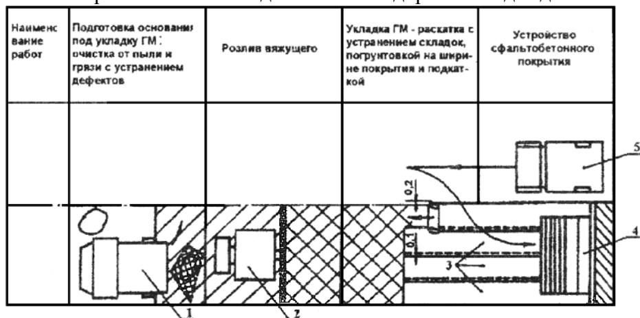
1 – машина для заделки трещин дорожных покрытий; 2 – автогудронатор; 3 – ГМ;
