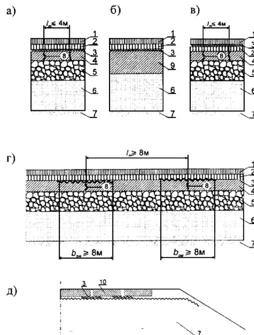
1, 2 – вновь устраиваемые асфальтобетонные слои усиления; 3 – трещинопрерывающая прослойка из ГМ; 4 – блочное асфальтобетонное основание (старое покрытие); 5 – основание дорожной одежды; 6 – песчаный подстилающий слой; 7 – земляное полотно; 8 – температурная трещина; 9 – слой дорожной одежды, содержащий неорганические вяжущие (цементогрунт, обработанный цементом щебень и др.); 10 – сборное железобетонное покрытие  $l_t$  – расстояние между трещинами;  $b_{GM}$  – ширина ГМ
