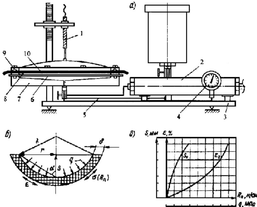
1 – датчик замера перемещений; 2 – рабочая камера насоса; 3 – станина; 4 – датчик замера давления  $q$ ; 5 – трубопроводы для подачи масла; 6 – мембрана; 7 – нижняя рабочая камера; 8, 9 – нижняя и верхняя кольцевые накладки для закрепления образца; 10 – образец ГМ
