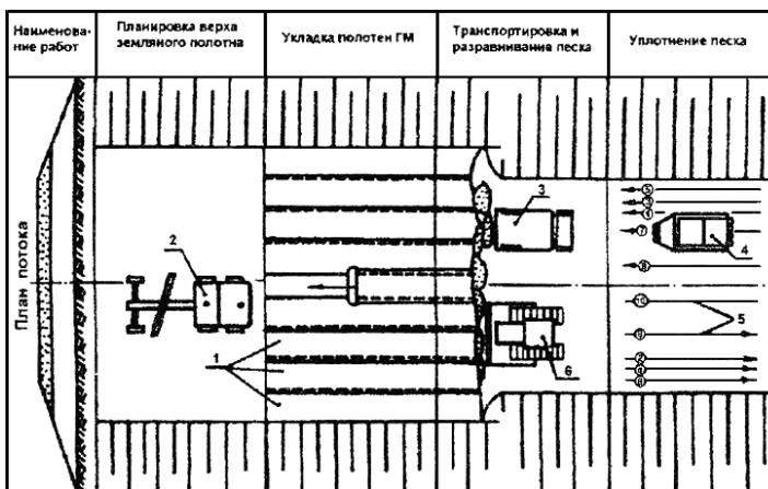
1 – ГМ; 2 – автогрейдер; 3 – автомобиль-самосвал; 4 – каток на пневмошинах;
