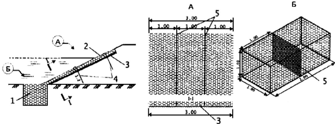
1 и 2 – габионы и габионы-“матрасы”; 3 – фильтр из Геотекстильного материала; 4 – анкер; 5 и 6 – диафрагмы в пределах одного габиона-“матраса” и габиона
