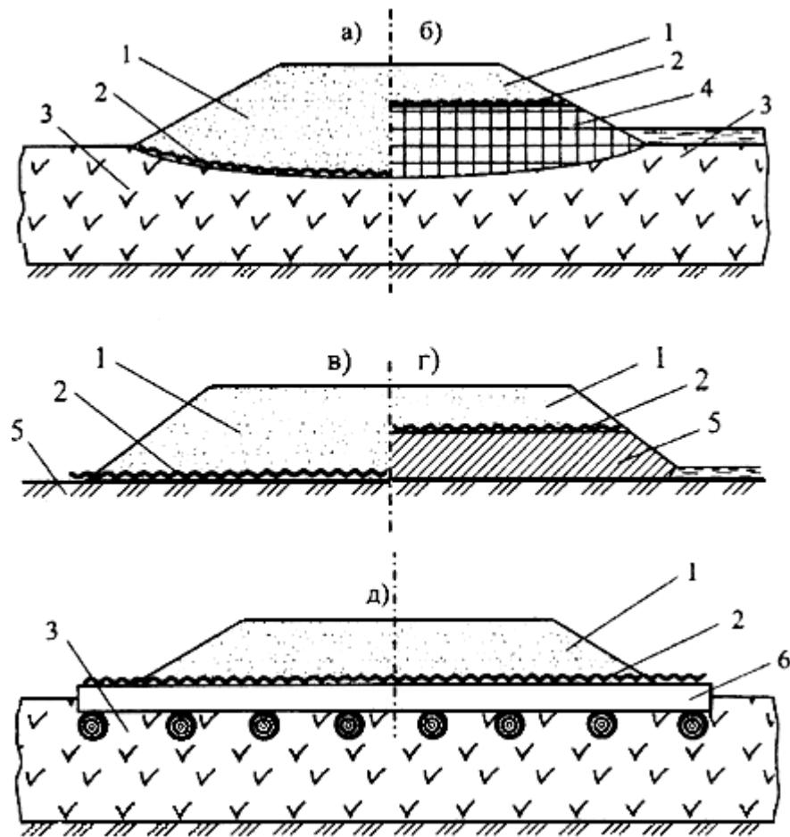
1 – насыпь; 2 – ГМ; 3 – слабый грунт; 4 – нижняя часть насыпи из торфа;
