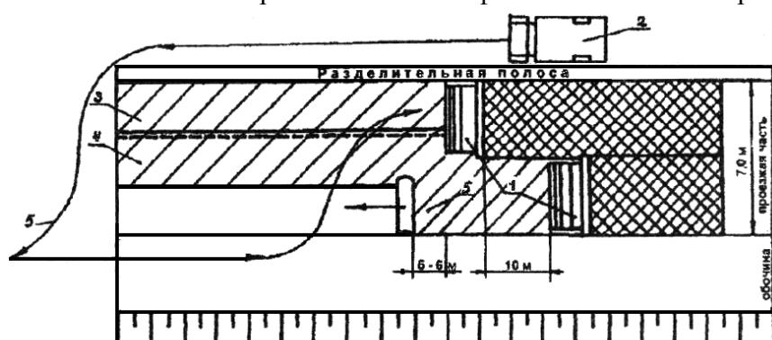
1 – асфальтоукладчик; 2 – автомобиль-самосвал; 3, 4 – уложенные полотна ГМ;
