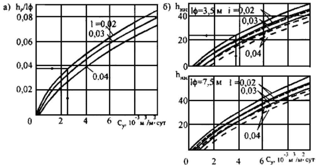
Рисунок 9.6 – Номограмма к расчету дренирующего слоя (определение  $h_{nac}$  и  $C$ )
