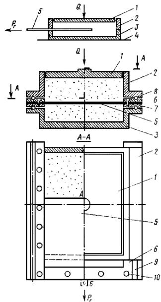
1 – штамп; 2, 3 – обоймы; 4 – основание; 5 – образец ГМ; 6, 7 – рамка; 8 – шарики в канавках; 9, 10 – винты
