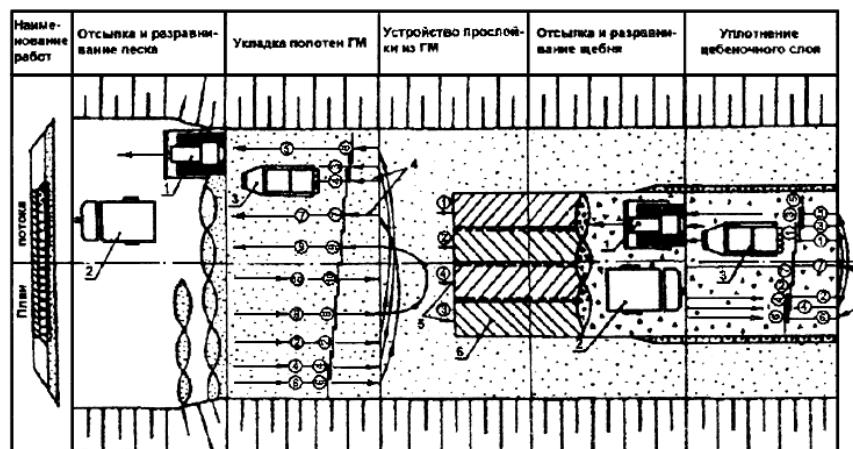
1 – бульдозер; 2 – автомобиль-самосвал; 3 – каток; 4 – последовательность прохода катка;
