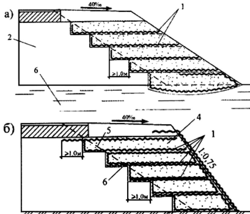
а – уширение насыпи на слабом основании; б – уширение насыпи в стесненных условиях;
