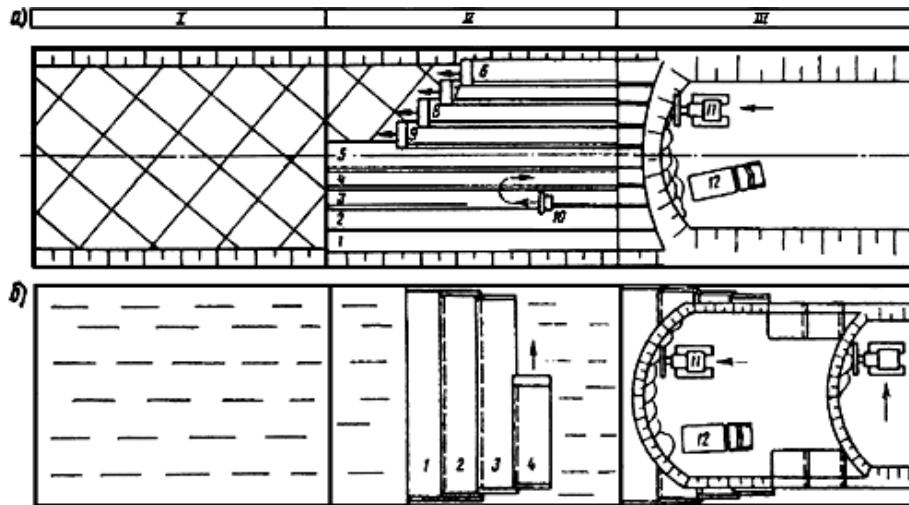
а – продольная укладка ГМ; б – поперечная укладка; 1-9 – рулоны (полотна) ГМ;
