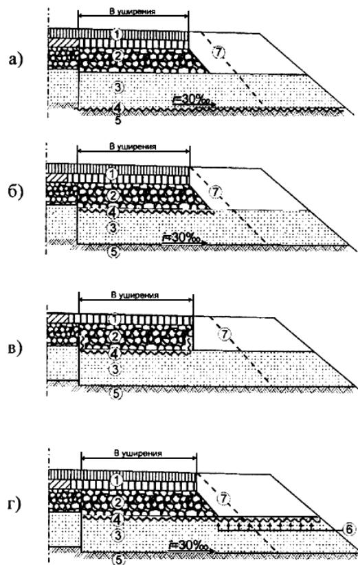
В уширения – ширина дорожной одежды в пределах уширения; обозначения 1-6 – по рисунку 8.1; 7 – контур существующего до уширения откоса
