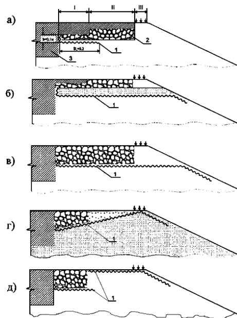
I – краевая укрепительная полоса шириной  $B_1$ ; II – остановочная полоса; III – прибровочная полоса; 1 – ГМ; 2 – конструкция укрепления; 3 – проезжая часть
