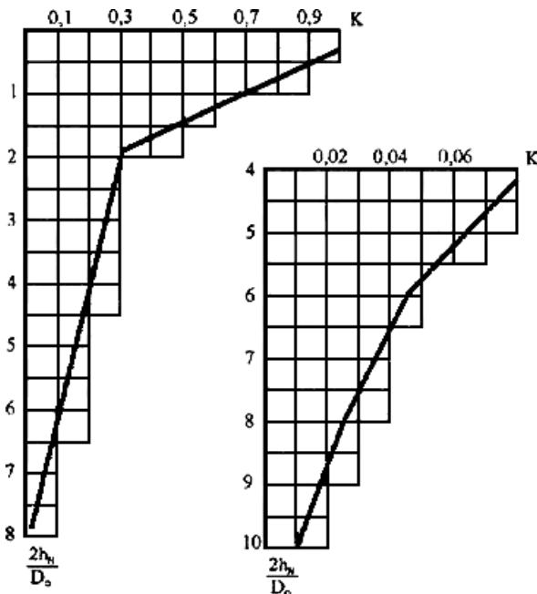
Рисунок 8.8 – Зависимость коэффициента распределения напряжений К от относительной глубины  $\frac{2 \cdot h_i}{D_0}$
