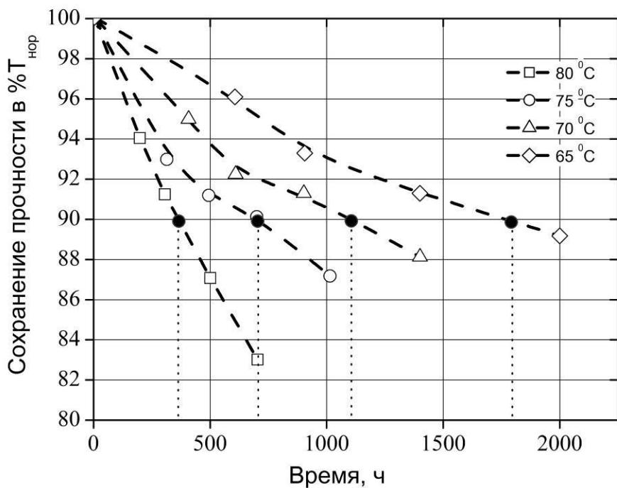
Рисунок 10.1 – Снижение прочности при заданных температурах
