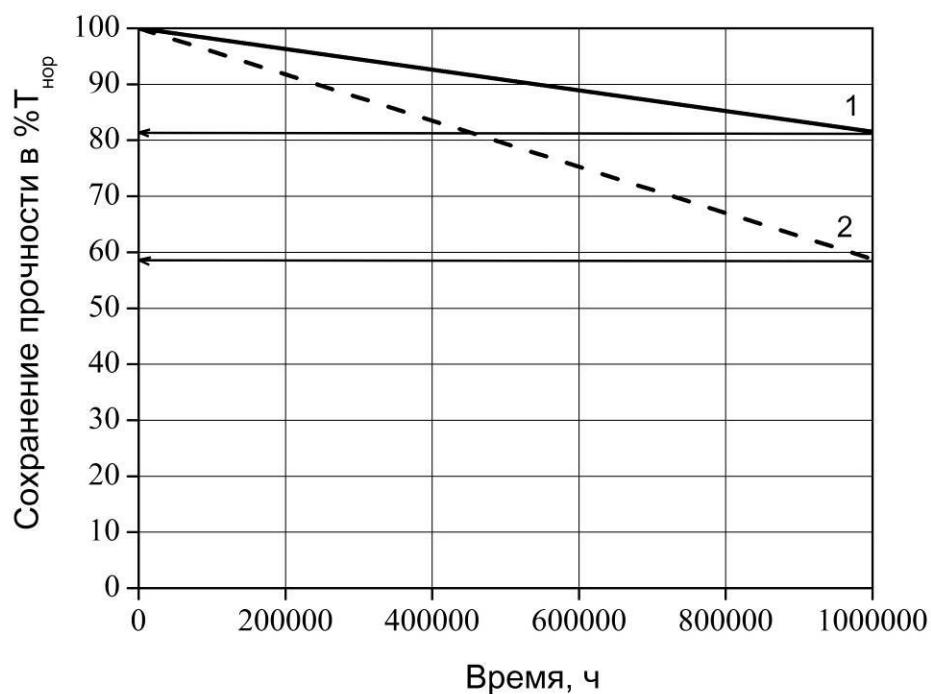
Рисунок 10.3 – Кривая старения при температуре эксплуатации
