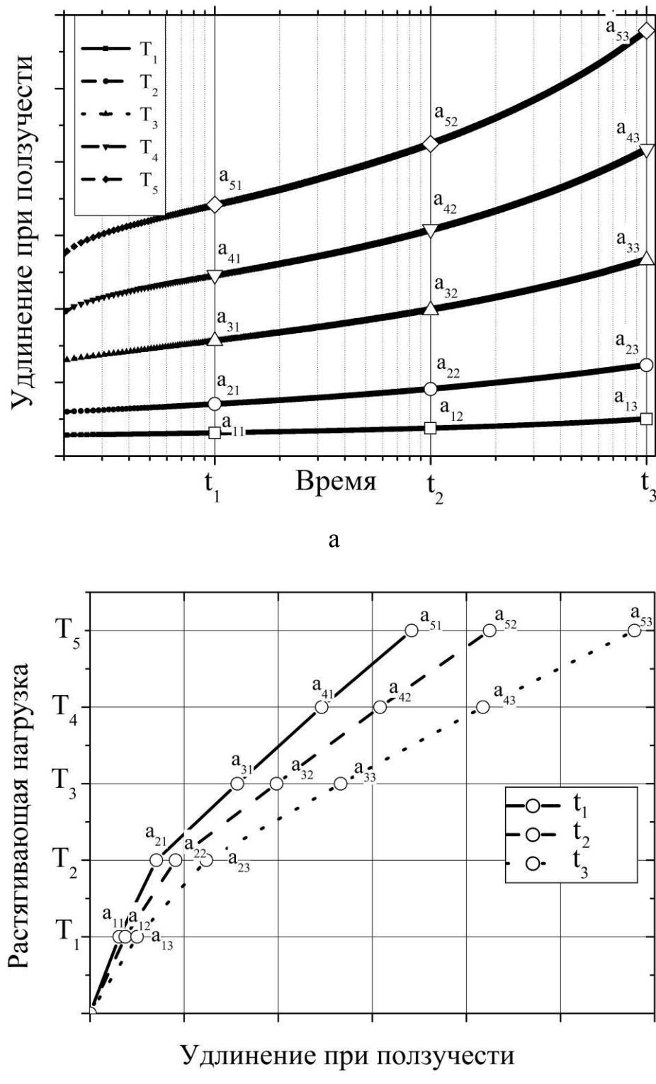
Рисунок 7.5 – Ползучесть геосинтетического материала (а) и изохронные кривые ползучести (б)
