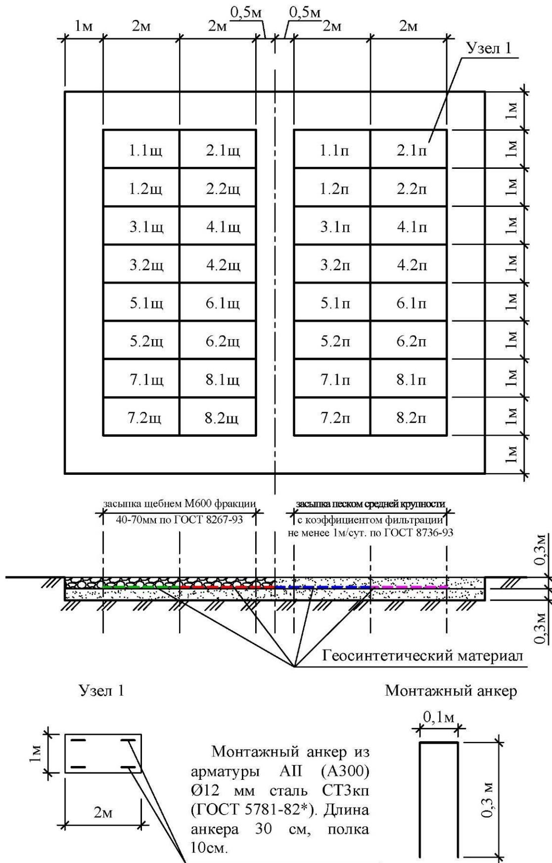
Рисунок 6.1 – Схема испытательного полигона
