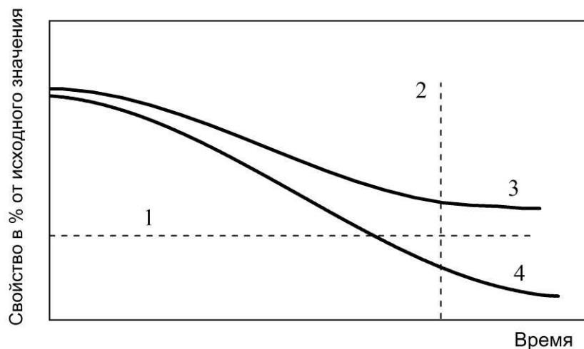
1 – минимально приемлемый уровень требуемого свойства; 2 – расчетный срок службы; 3 – доступное свойство при приемлемом варианте; 4 – доступное свойство при неприемлемом варианте
