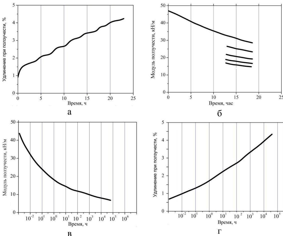
Рисунок 7.8 – Метод ступенчатых изотерм
